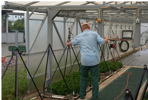
Abb. 1: Wiegen eines Lysimeters mit Petersilie
