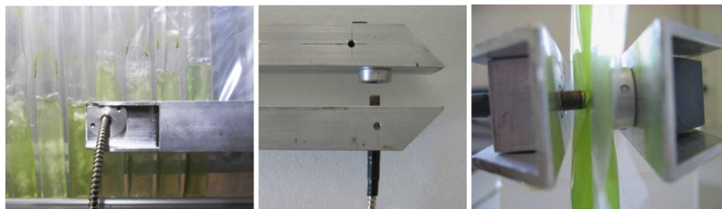
Abb. 1: Messkopf mit eingespannter Kulturmatten. Links: Frontansicht. Mitte: Aufsicht des Messkopfes ohne Matte. Rechts: Detailansicht mit eingespannter Anzuchtmatte
