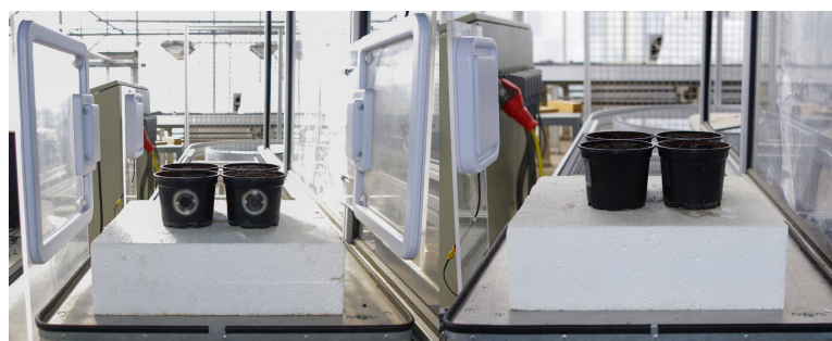
Abb. 1: Versuchsaufbau, links: HF mit Antennengate; rechts: UHF mit Einzelantenne
